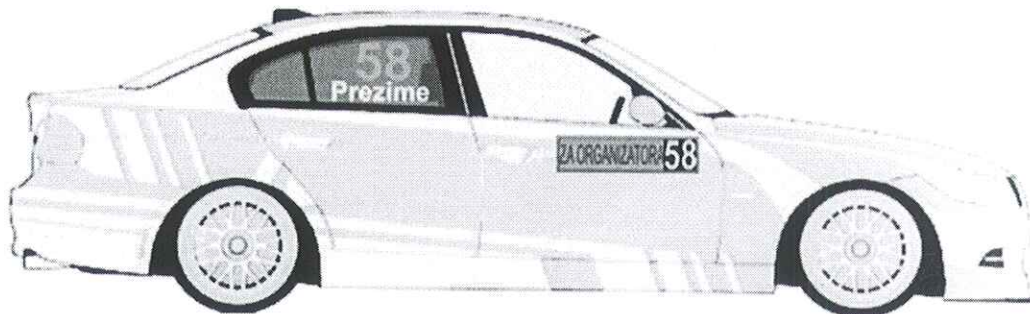
Задњем ветробранском стаклу. број је висине 14cm са дебелином линије од 2cm, font је Arial BOLD
