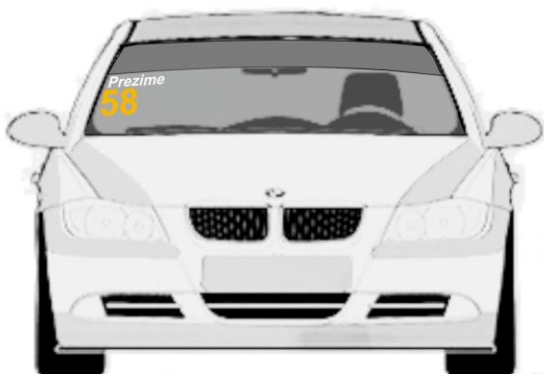
Prednjem vetrobranskom staklu. broj je visine 14cm sa debljinom linije od 2cm, font je Arial BOLD
