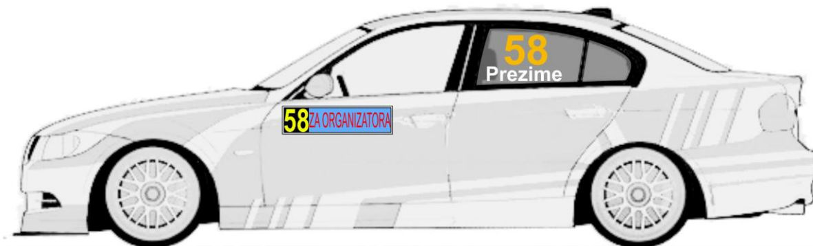
Zadnjim levim i desnim bočnim staklima, broj je visine 20cm sa debljinom linije od 2.5cm, font je Arial BOLD
