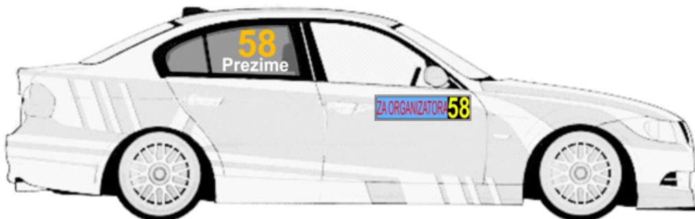
Задњем ветробранском стаклу. број је висине 14cm са дебелином линије од 2cm, font је Arial BOLD
