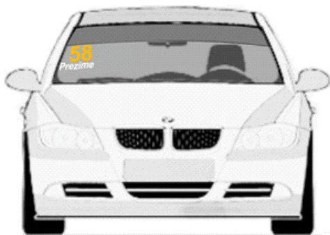
Предњем ветробранском стаклу. број је висине 14cm са дебелином линије од 2cm, font је Arial BOLD
